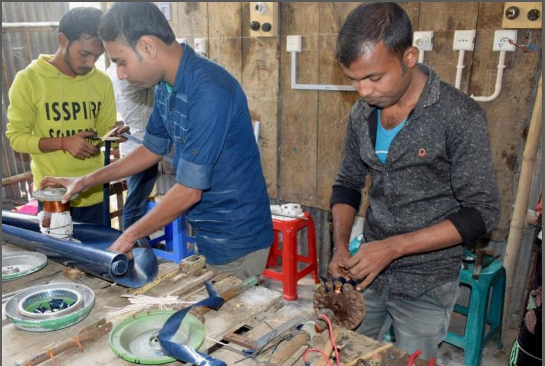
Diese jungen Männer üben im Ausbildungszweig Elektromotor-Reparatur die Neuwicklung von Elektromotoren mit Kupferdraht.
